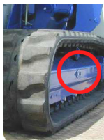
Fig. 66 Bolten for strammerullen er placeret her.
