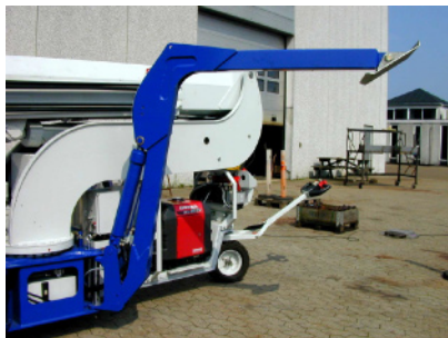
Fig. 12 Støtteben drejet væk fra liften
