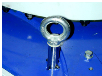
Fig. 10 Låsebolt løftet/støtteben ikke låst
