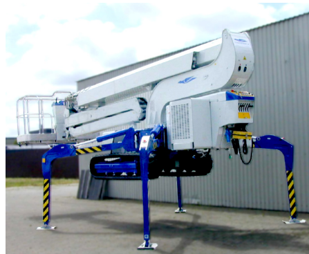
Fig. 58 Liften løftet ved hjælp af støttebenene
