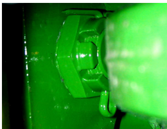
Fig. 68 Bolt – Bælter ikke strammet.
