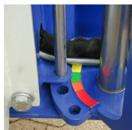
Fig. 17 Støtteben i standardposition.
